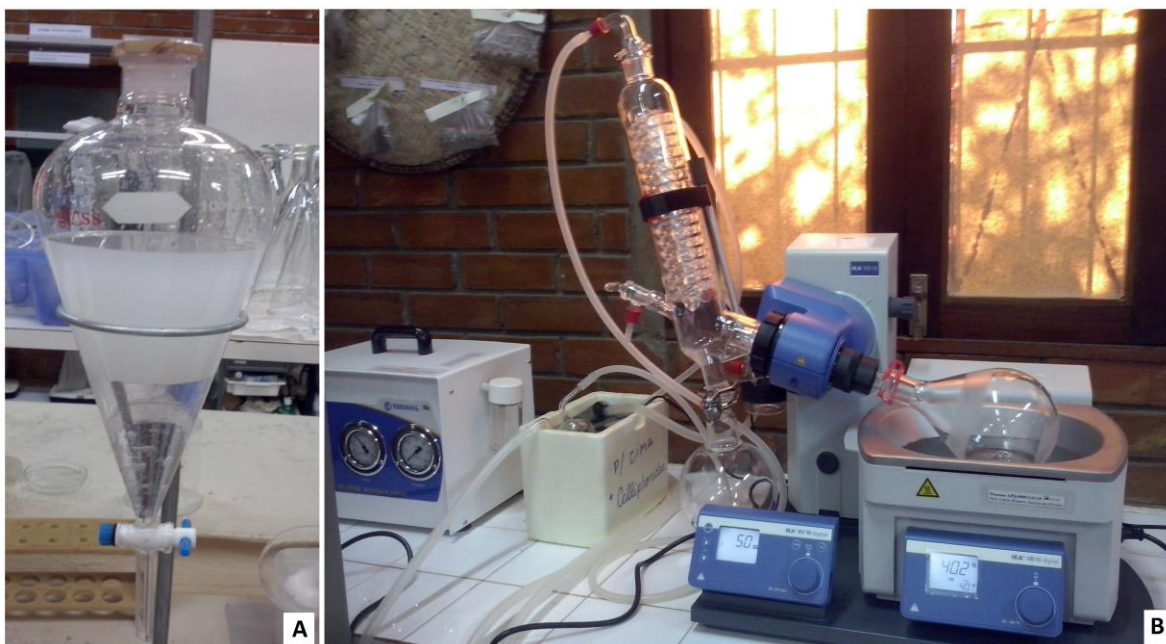
Figura 4: Funil de separação (A) e rota-evaporador acoplado à bomba de vácuo e pressão (B), para extração de óleo essencial.
