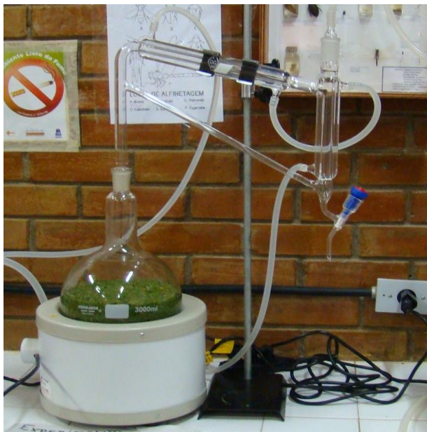
Figura 2: Processo de hidrodestilação utilizando o equipamento tipo Clevenger, para obtenção do óleo essencial.
