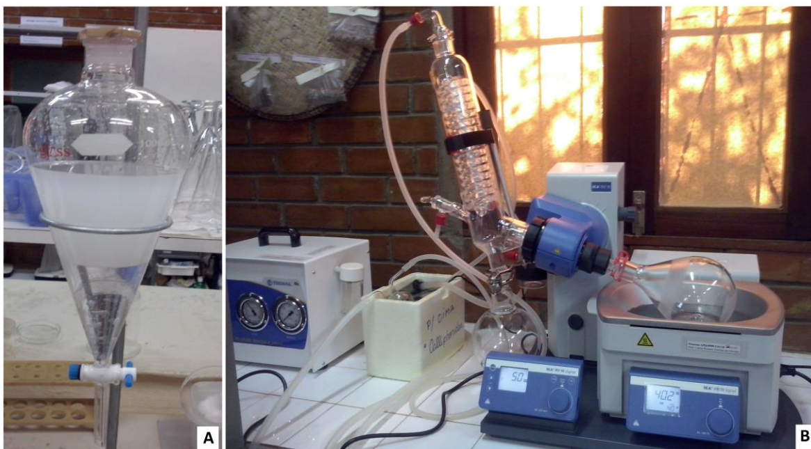
Figura 3: Funil de separação (A) e rota-evaporador acoplado à bomba de vácuo e pressão (B), para extração de óleo essencial.
