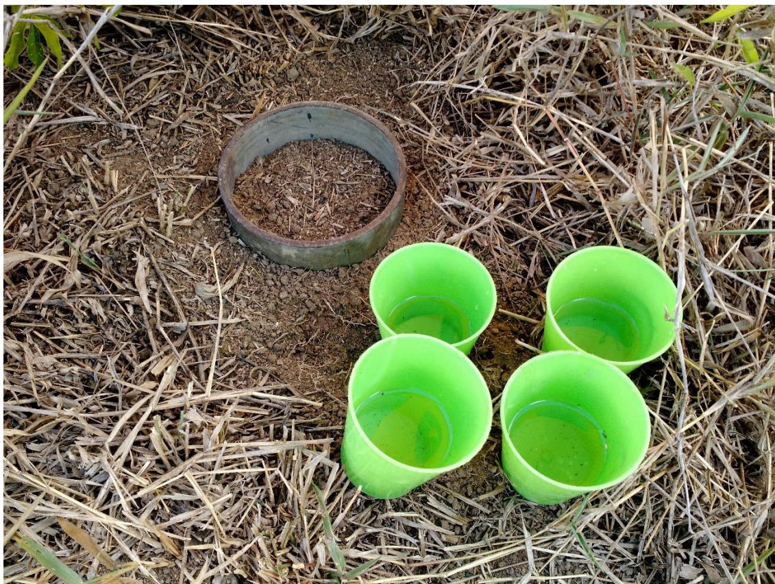
Figura 3: Teste de infiltração com anel simples de 15 cm.
